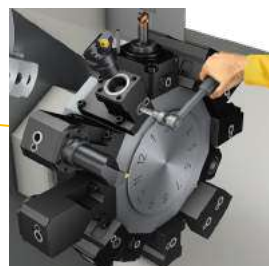
Torre com sistema de ferramentas Coromant Capto®
